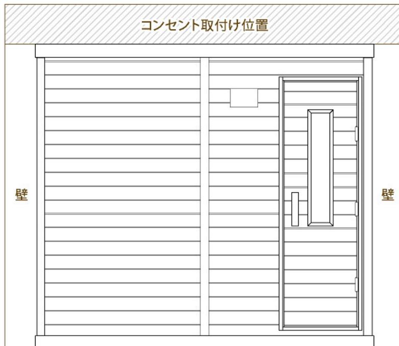
最近の一般住宅では、エアコン・冷蔵庫・IHクッキングヒーター等の200Vの電化製品が普及し200Vが引き込まれています。分電盤まで200Vが来ていれば、サウナを置く場所のコンセントまで室内配線工事するだけです。
